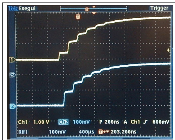
Fig. 7 Segnali per R_O > Z_0 , e linea aperta all'estremo remoto.
